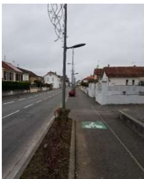
Figure 32 : aménagement de la rue Ollé Laprun : Piste cyclable séparée en direction du centre de Jurançon et bande cyclable en direction de l'avenue Henri IV
