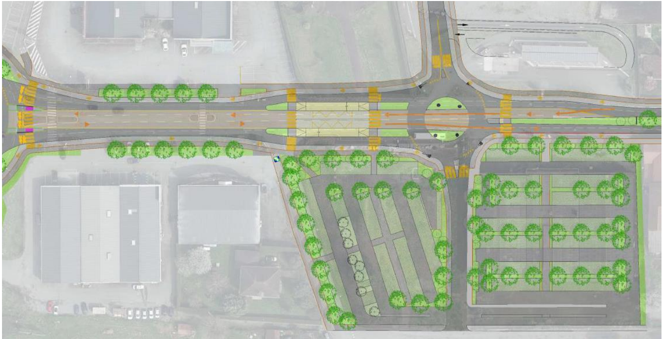
Figure 6 : Création prévue d'un parking relais et d'un giratoire pour desservir ce parking et Intermarché
