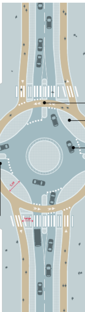
Figure 5 : Giratoire : le schéma type de recommandation, sur le « Guide des aménagements cyclables » proposé par l'association Paris en Selle.
